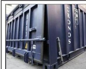
为满足特殊的货物种类及运输方式而设计，包括开顶集装箱（Opentops），框架集装箱（Flatracks），可拆卸集装箱（Swapbodies Container），宽体箱（SeaCell）等箱种。
