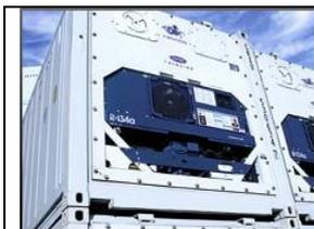
冷藏集装箱有绝缘不锈钢侧板、顶板和复合地板，并在集装箱前部设有外部温度控制单元，以便调节集装箱内部温度。适合运输冷冻和冷藏食品如肉类，鱼类，水果和蔬菜。
