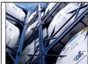
又称液体集装箱，是为运输食品、药品、化工品等液体货物而制造的特殊集装箱，其结构是在一个金属框架内固定上一个液罐。
